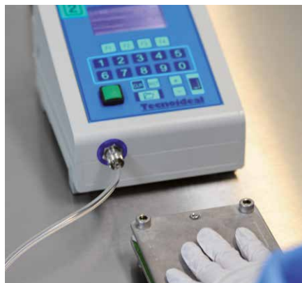
Test de mesure de la perte de pression, avec air filtré
